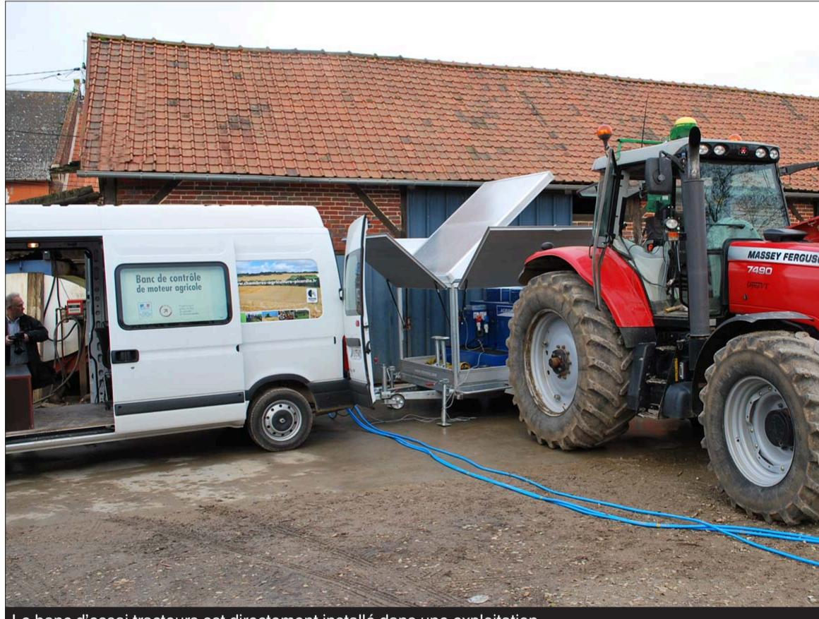
Le banc d'essai tracteurs est directement installé dans une exploitation.
