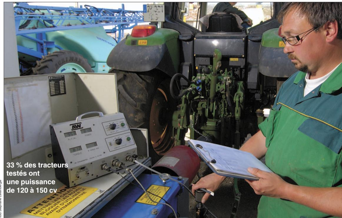
Les Chambres d'agriculture de Picardie proposent, depuis début 2011, de réaliser un diagnostic des moteurs de tracteurs. L'analyse de ces données permet de connaître la plage d'utilisation optimale de son tracteur et de vérifier la bonne santé du moteur.
